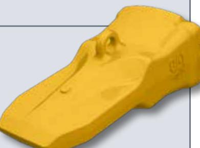
Scharfe Plus-Zahnspitzen sind aus 25% verschleißfesterem Material gefertigt und weisen eine um 25% geringere Querschnittsfläche des Führungsmessers auf. Die scharfen Plus-Zahnspitzen bleiben über den kompletten Einsatzzeitraum scharf. Sie sind ideal für lehmige Materialien geeignet
