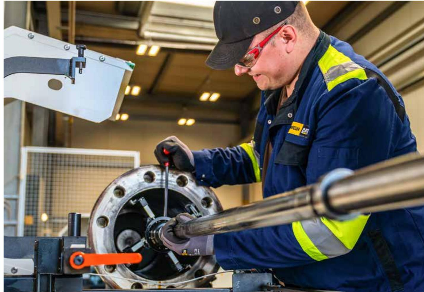
Gerade im Winter sind hydraulische Komponenten wie Hydraulikzylinder stärker beansprucht. In den Verschleißriefen können sich bei Frost Eiskristalle bilden. Das beschleunigt den Dichtungsverschleiß ganz erheblich.
