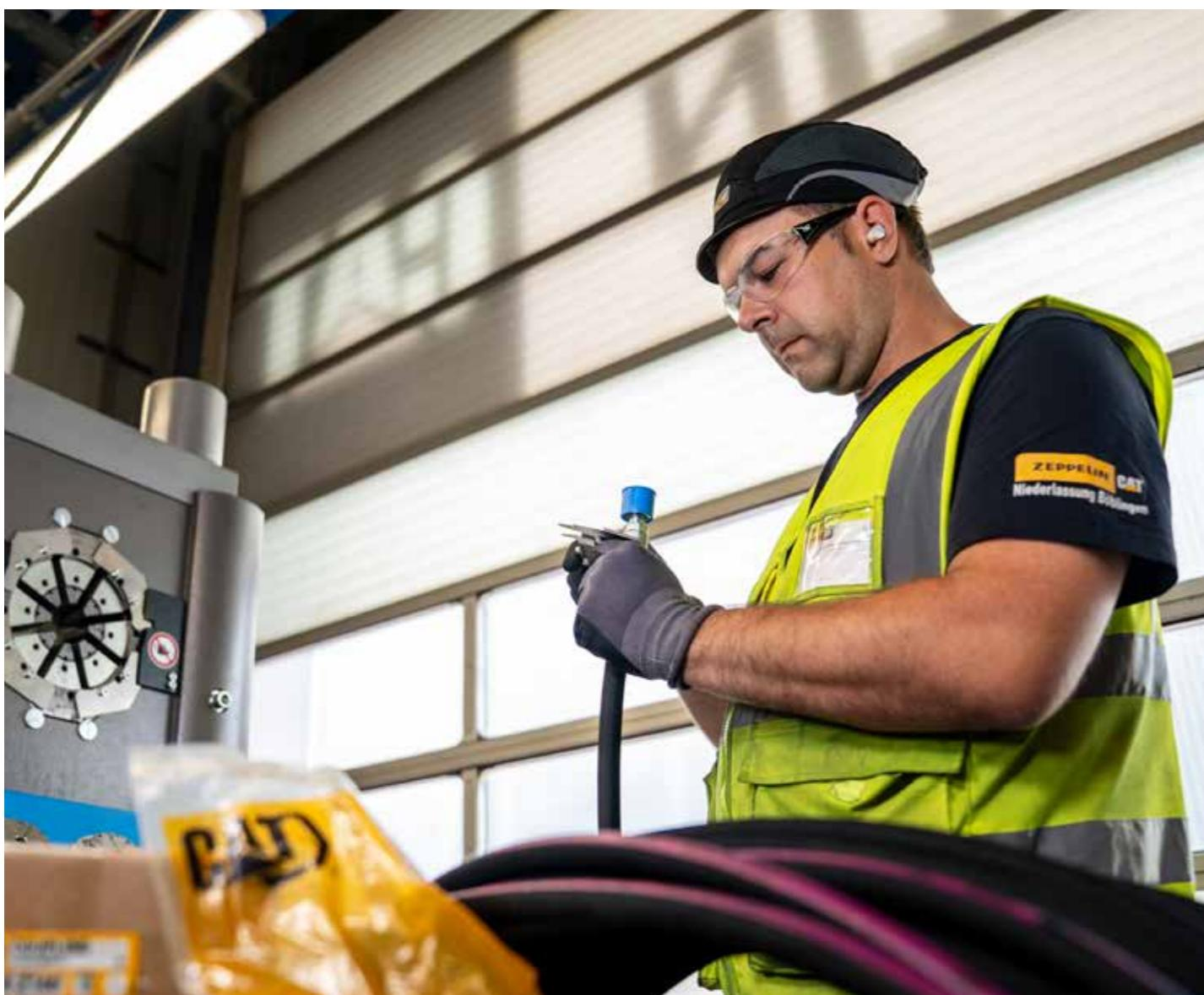
Hydraulikschläuche sind Verschleißteile unter Hochdruck. Deshalb müssen sie regelmäßig untersucht und bei Bedarf fachmännisch instandgesetzt oder getauscht werden!
