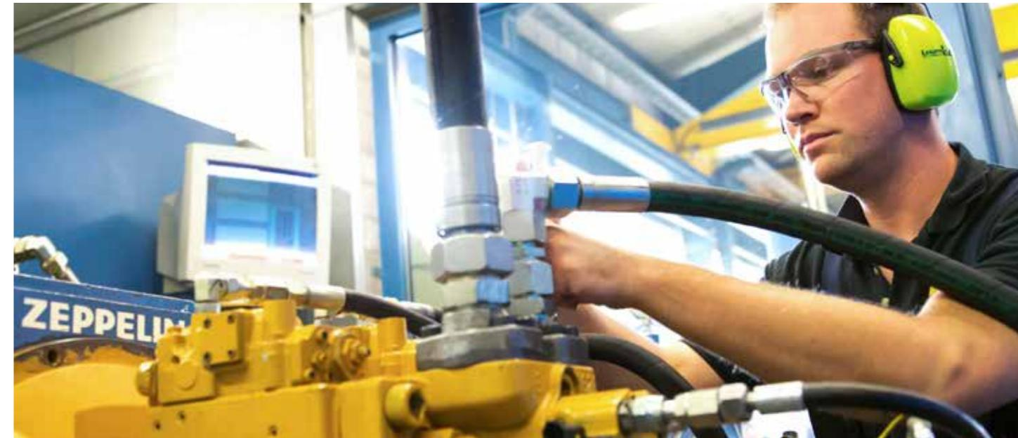
Die Reparatur und Instandhaltung von Hydraulikpumpen und -motoren übernehmen wir neben Baumaschinen auch für Landmaschinen, Stapler und Industrieanwendungen (z. B. für Marken wie Bosch Rexroth, Kawasaki, Linde oder Sauer). Auch hier bieten wir das Paket aus werksüberholten Aggregaten, Fixpreisen und zertifizierter, Prüfstand getesteter Qualität. Mit über 100 überholten Pumpen und Motoren auf Lager können wir oft den sofortigen Austausch bieten.
